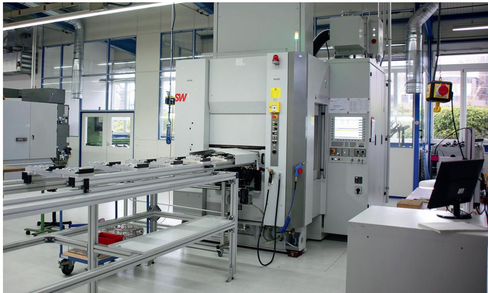
1 Das vollautomatisierte SW-Doppelspindel-Bearbeitungszentrum BA 321 produziert alle drei Minuten zwei fertig bearbeitete Pinzettenhälften © Klaus Vollrath
